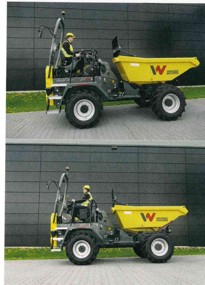
Die Drehung der Sitz- und Bedienkonsole kann bequem vom Fahrersitz aus durchgeführt werden
